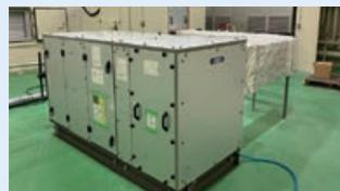
総合実験棟でのエアハンドリングユニットの冷房能力試験
