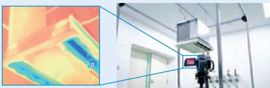
温湿度可変室でのファンコイルユニットの結露試験
