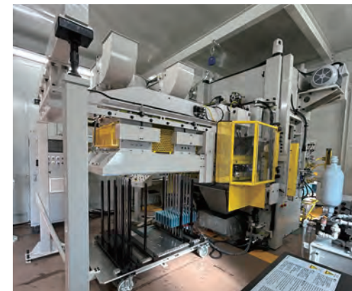
引进新型WA盘管用翅片冲床生产线
