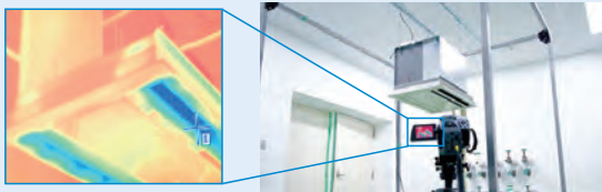
温湿度可变房间的风机盘管机组的结露试验
