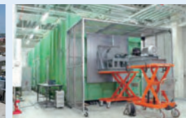
送风机性能试验装置（AMCA）
