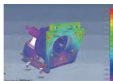
PS型插入风机构造分析
