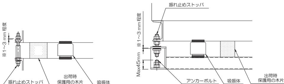
図2-12 吸振体と振れ止めストッパ分離タイプ
